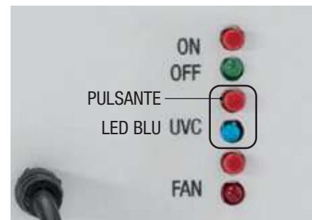
Foto 3: il secondo tasto in basso, consente di forzare l'accensione dei LED UV-C all'interno del prodotto, questa modalità si ottiene tenendolo premuto per almeno cinque secondi, il Led blu acceso indicherà la messa in funzione.
