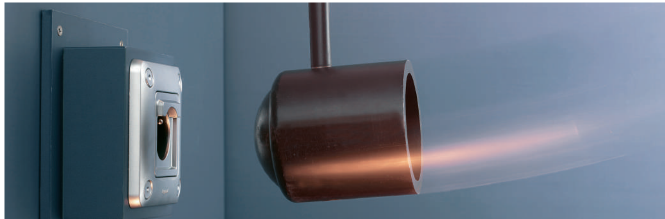
IK 10 : RESISTÊNCIA MÁXIMA AOS CHOQUES | Todos os produtos resistem a um impacto de 20 joules
